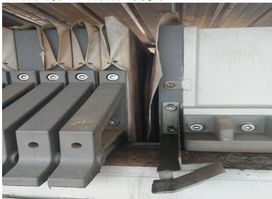
卸压之后的滤板
