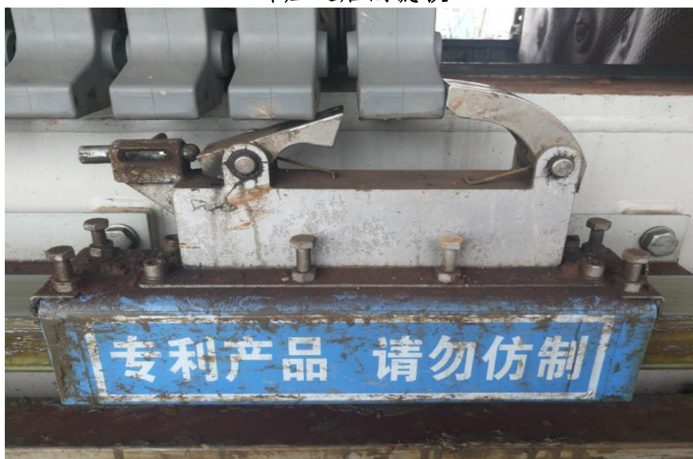
自动拉板拖动滤板过程
